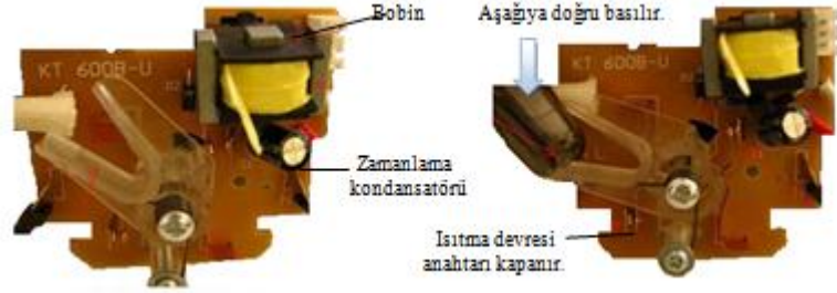
Resim 1.11: Ekmek kızartıcı elektronik devre görünüşü
