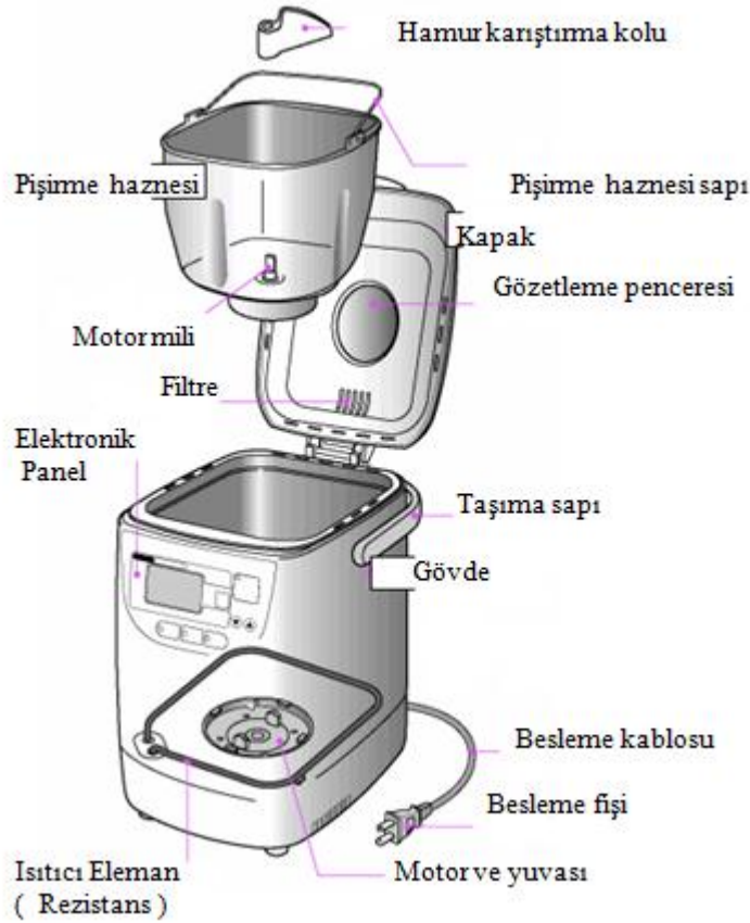
Resim 4.4: Ekmeğin yapma makinesinin parçaları
