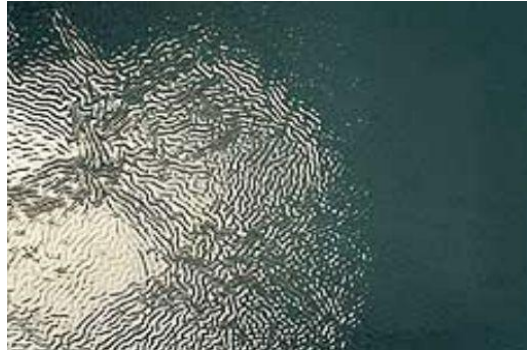
Resim 3.1: Boyada kırışma olayı
