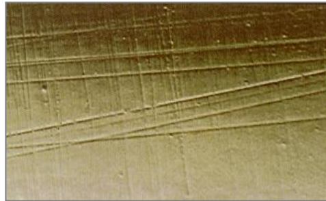
Resim 2.4: Yüzeydeki zımpara izleri
