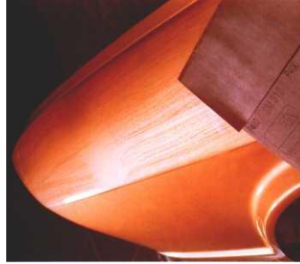
Resim 2.6: Oto boyasında zımpara izlerine bir örnek
