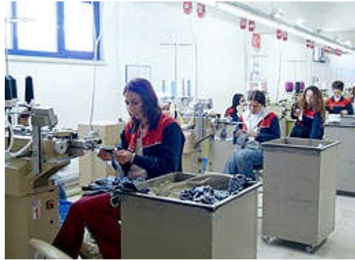
Resim 2.5:Rosso burun kapama makinesinde burun kapama işlemi
