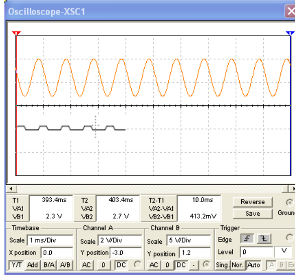
Fotoğraf 2.2: Schmitt tetikleyici devresi giriş ve çıkış sinyalleri
