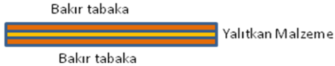
Şekil 4.2: İki yüzeyi bakır kaplı baskı devre kartı
