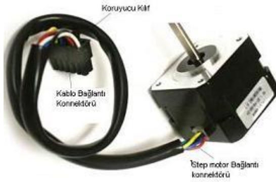
Fotoğraf 1. 3: Step motor kablo bağlantıları
