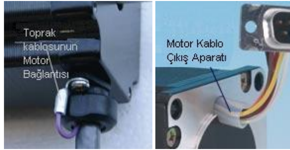
Fotoğraf 1. 2: Step motor kablo bağlantıları
