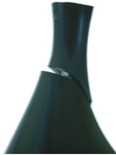
Fotoğraf 3.3: Ökçe yorulma testinde kırılmış bir ökçe
