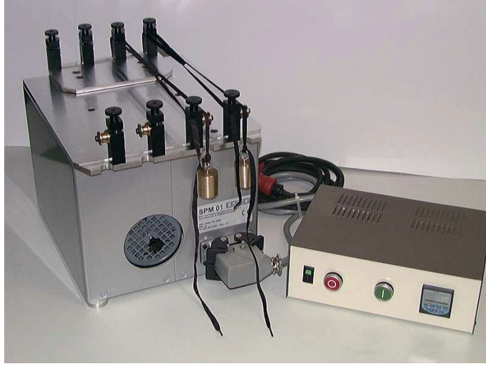
Fotoğraf 2.2: Ayakkabı bağcıkları aşınma dayanımı testi cihazı
