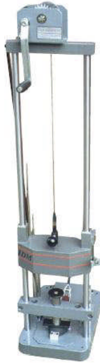
Fotoğraf 5.2: Bombe darbe dayanımı test cihazı
