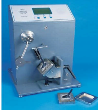
Fotoğraf 3.1: Ökçe yorulma testi cihazı
