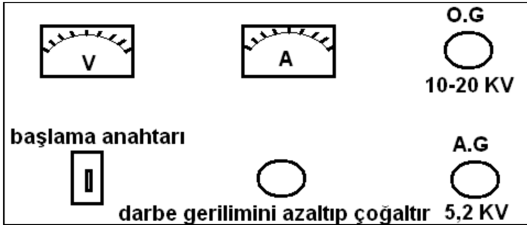
Şekil 3.4: Arızalı kabloya verilen akım ve gerilimin görülmesi
