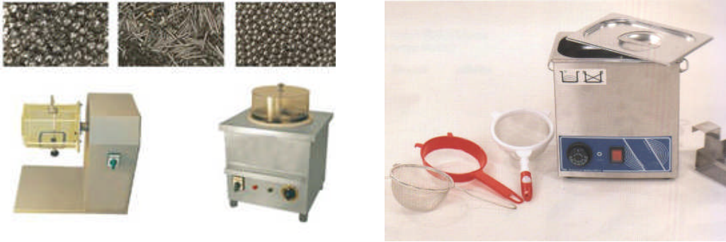
Resim 2.2: Temizlemede kullanılan araç gereçler (bilyeli dolap ve yıkama makinesi)
