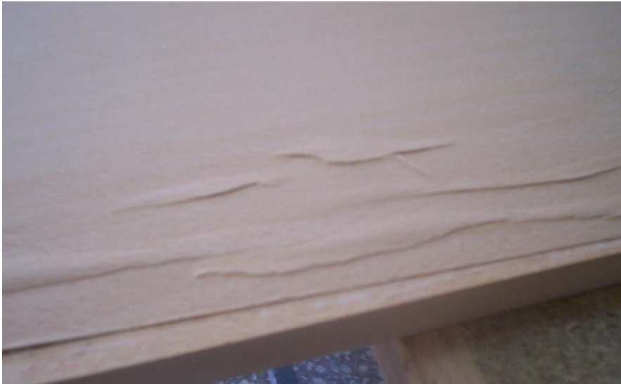
Resim 2.1: Kaplama hataları oluşmuş bir iş parçası
