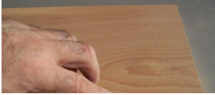
Resim 2.4: Kabarmanın el ile kontrolü
