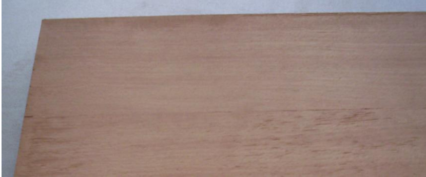
Resim 2.5: Kaplama yüzeyinde görülen çatlama
