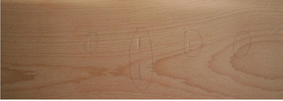
Resim 2.7: Kaplama yüzeyinde ezilme
