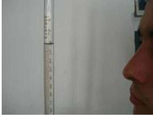
Resim 3.1: Büretin göz seviyesinde okunması
