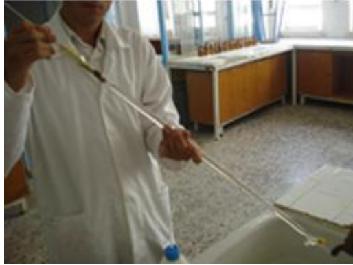
Resim 3.2: Büret fırçası ile büret temizliđi
