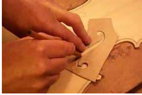
Resim 1.2: 'f' deliklerinin şablon ile çizilmesi
