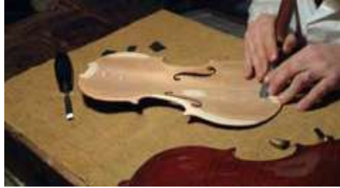
Resim 2.1: Ses tablosunun iç bombesinin düzeltilmesi
