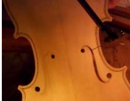
Resim 1.4: 'f' deliklerinin kıl testeresi ile kesilmesi
