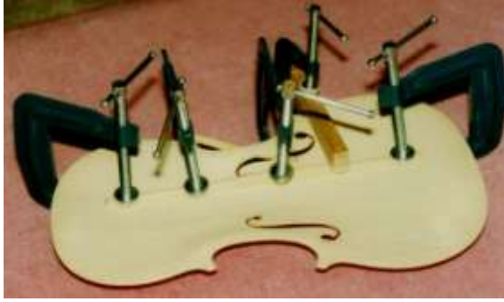
Resim 2.8: Bas ıtasının yapıřtırılması
