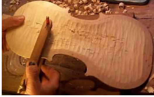
Resim 2.12: Alt tablonun iç bombesinin ölçülmesi
