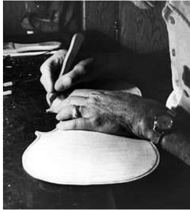
Resim 2.8: Fileto kanallarının boşaltılması
