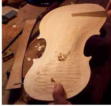
Resim 2.6: Bombe şablonu ile kontrol
