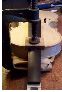
Resim 2.6: Sapın armonik kasaya yapıştırılması
