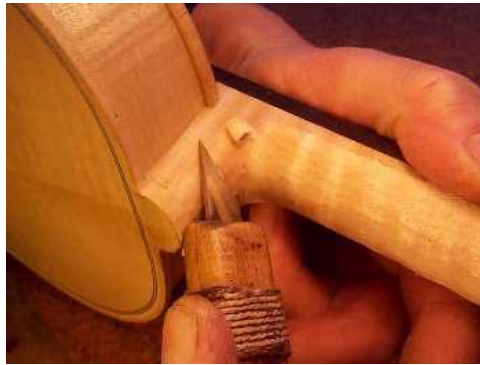
Resim 2.7: Sap formunun verilmesi
