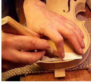
Resim 2.2: Armonik kasada markalama
