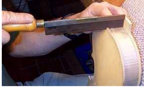
Resim 2.3: Armonik kasada kesim
