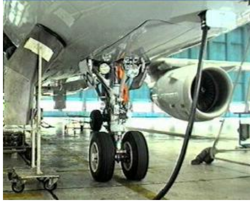
Resim 4.3: Uçağın jake alınması ve elektriksel güç verilmesi
