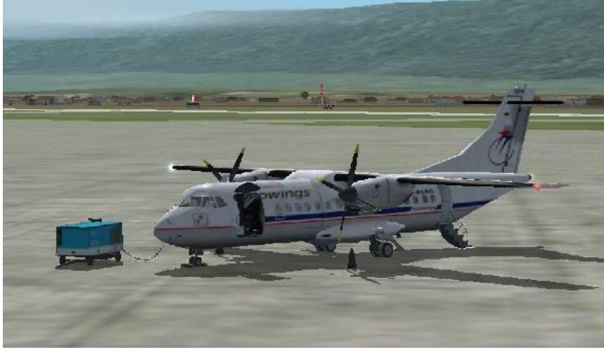
Resim 4.1: Ground power ile park hâlindeki uçağa elektrik verilmesi
