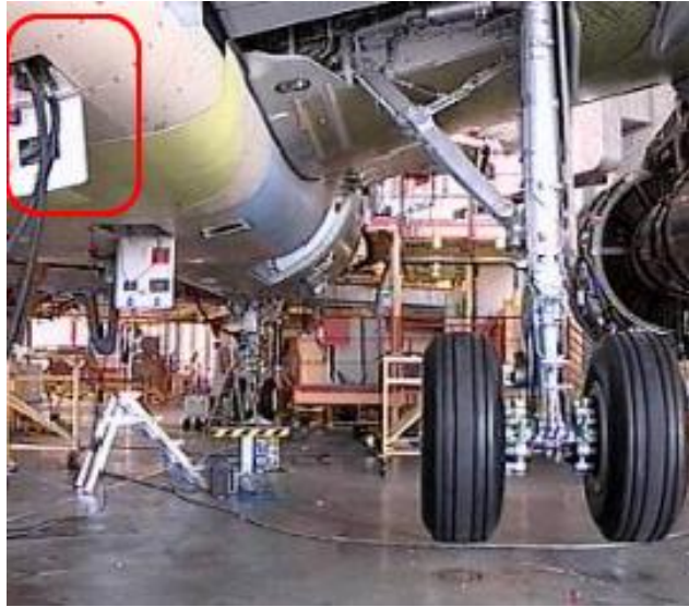
Resim 4.2: Bakıma alınan uçağa elektrik verilmesi
