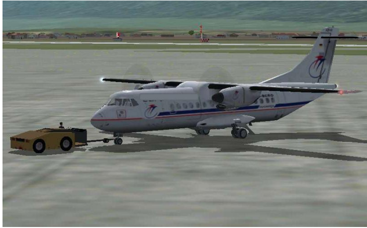
Resim 1.1: Push-back aracı ile uçağın çekilmesi
