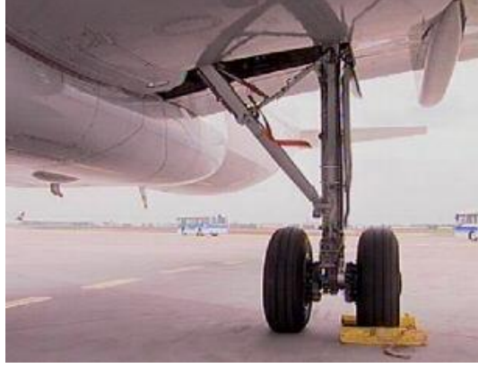
Resim 2.4: Lastikleri takozlanmış ve iniş takımı pinleri takılmış park hâlindeki uçak
