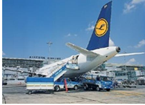
Resim 3.3: Yakıt ikmal aracının yanaştığı uçağa ikmal yapılması
