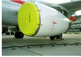
Resim 2.2: Motor hava girişinin kapatılması
