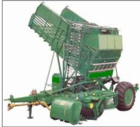
Resim 4.3: Tam otomatik depolu-elemeli patates hasat makinesi
