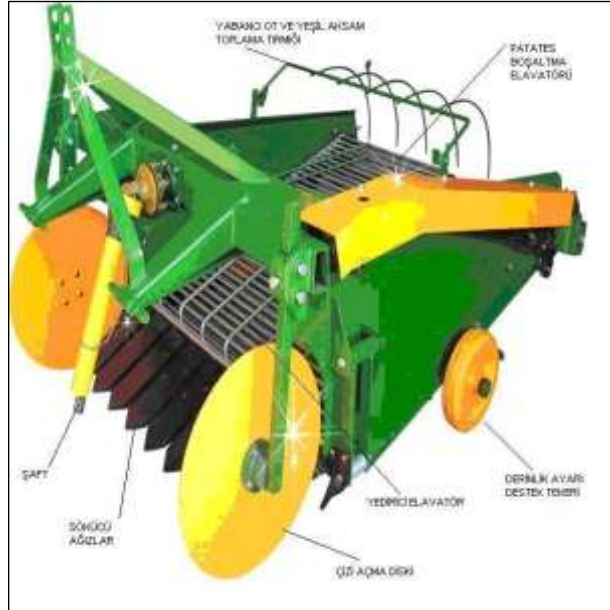
Resim 4.4: Elemeli tip patates hasat makinesinin parçaları
