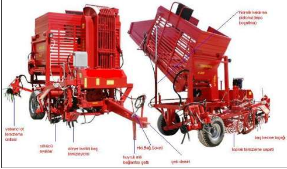
Resim 3.3: Çekili tip depolu tam otomatik şeker pancarı hasat makinesinin parçaları
