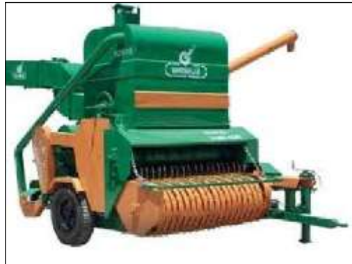
Resim 2.1: Yeni tip pikap tertibatlı harman makinesi
