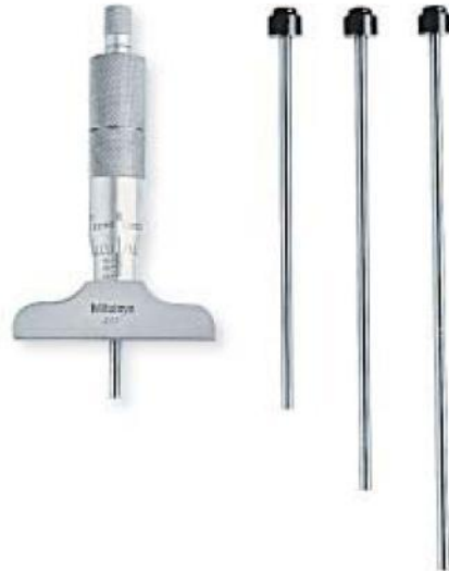
Şekil 2.8: Derinlik mikrometresi ve milleri
