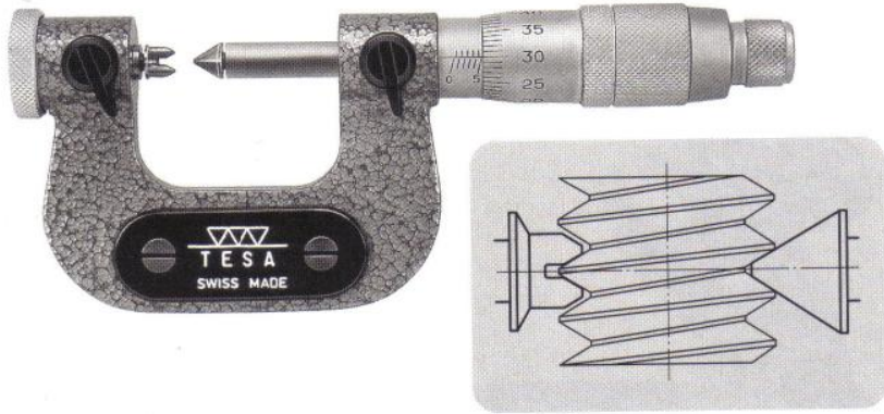
Şekil 2.9: Vida mikrometresi ve kullanımı
