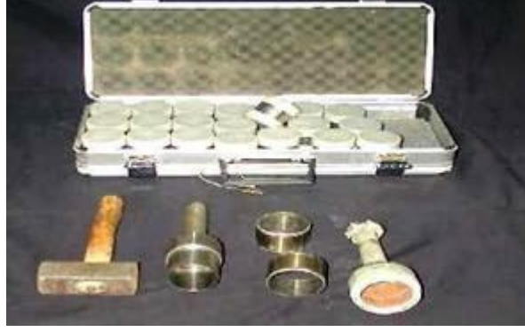
Resim 1.3: Bozulmamış toprak numunesi alma kapları
