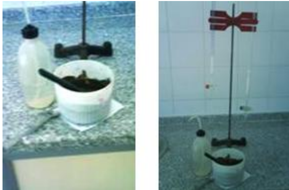
Resim 3.1: Saturasyon macunu hazırlamada kullanılan malzemeler
