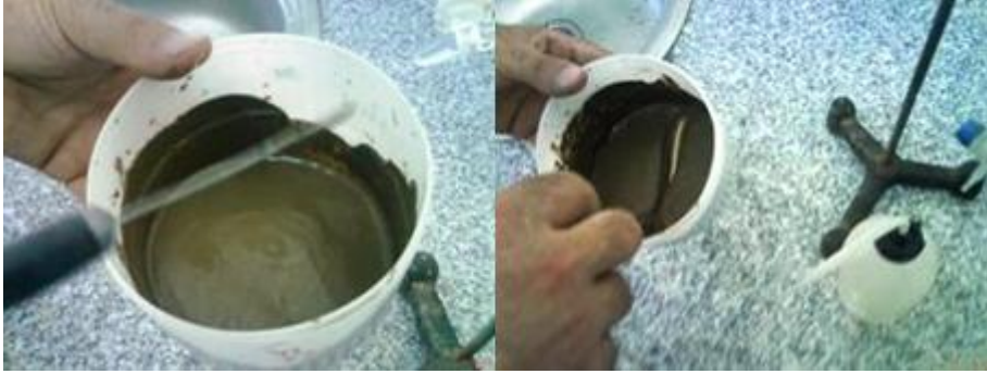
Resim 3.2: İdeal doygunluk şartları sağlanmış saturasyon macunu
