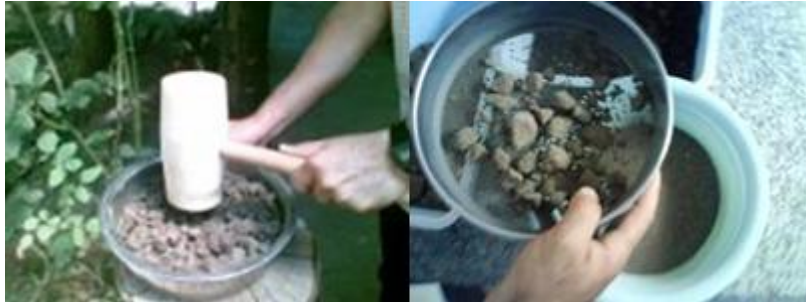
Resim 2.3: Numunelerin havanda dövülerek öğütülmesi ve elenmesi
