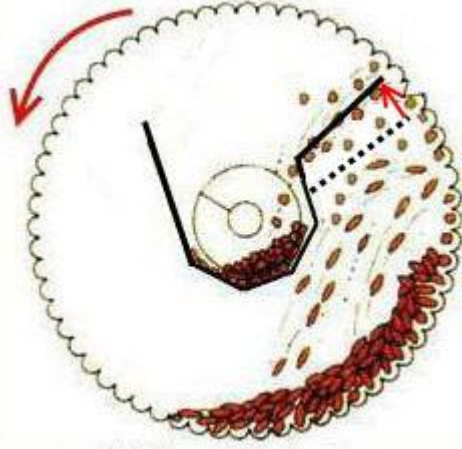
Resim 4.5: Toplama oluğu fazla yukarı alınmış bir triyör
