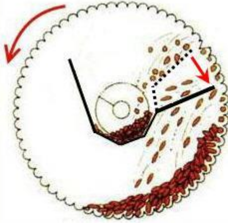
Resim 4.6: Toplama oluğu fazla aşağıya alınmış bir triyör
