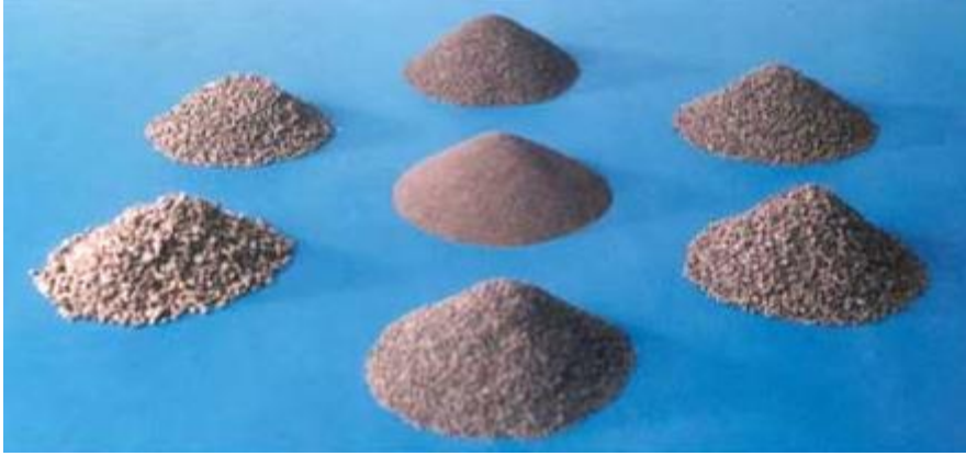
Şekil 7.2: Zımparayı oluşturan değişik özellikte kum tanecikleri
