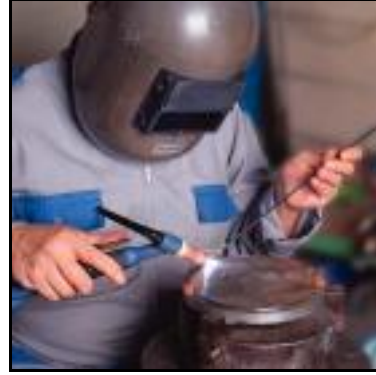
Şekil 1.7: TİG kaynağının yapılışı
