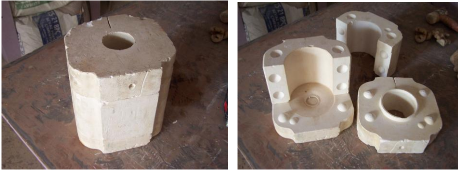
Resim 1.19: Kalıpların açma ve kapatma kontrolü
