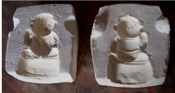
Resim 2.3: Kalıpların açma kapama sisteminin kontrolü
