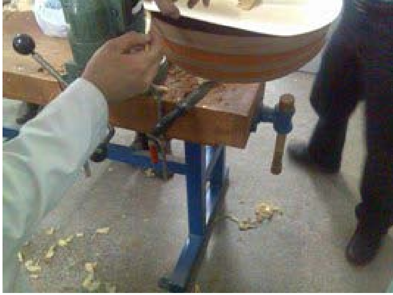
Resim 2.3: Tekneye kırlangıçkuyruğu açma
