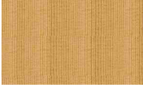
Resim 1.3: Ses tablosunda kullanılacak ağaç malzemenin elyaf durumu
