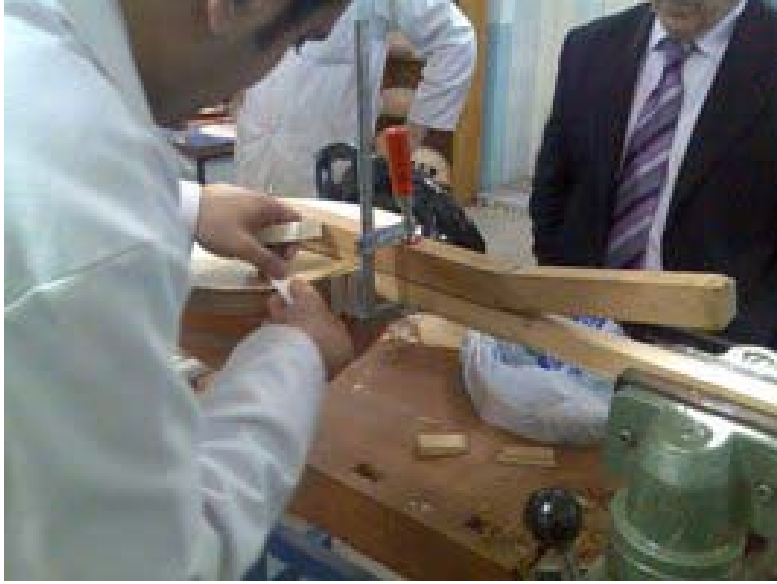
Resim 2.4: Tekneye kırlangıçkuyruğu açma
