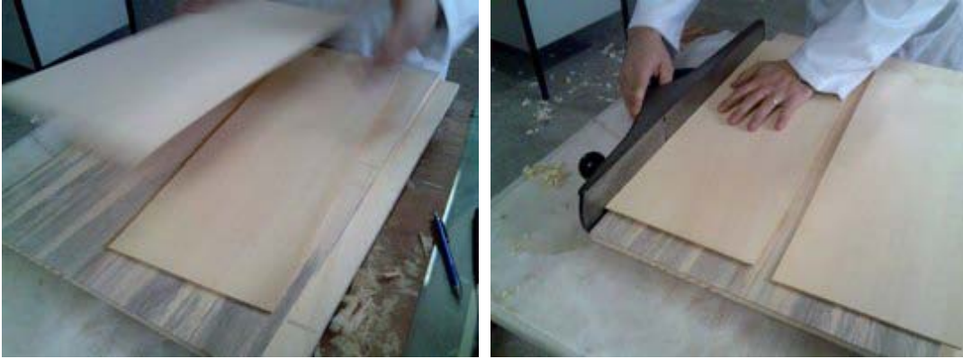
Resim 1.5: Ses tablosunun alıştırılması
