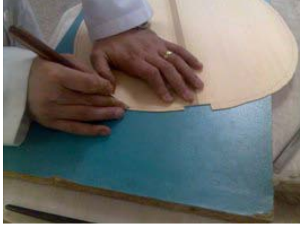
Resim 2.2: Ses tablosunun fazlalıklarının alınması
