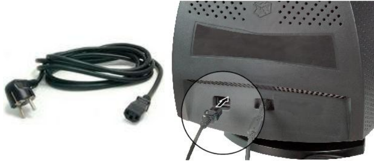
Resim 3.4: Monitörün elektrik besleme kablosu ve monitöre takılması
