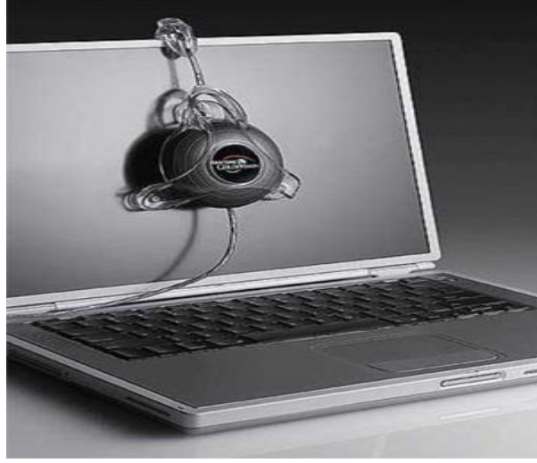
Resim 3.6: Monitör kalibrasyonu için spektrofotometre bağlantısı
