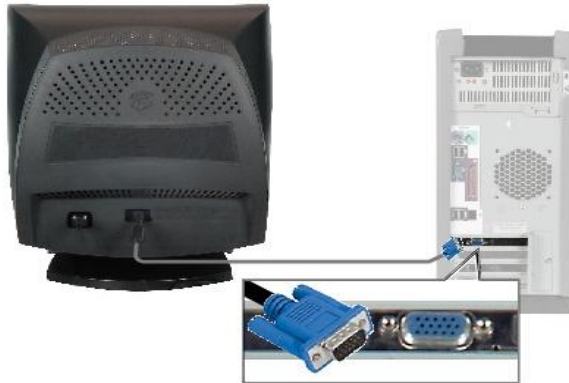
Resim 3.2: PC kasası ile monitörü arasındaki bağlantının yapılışı
