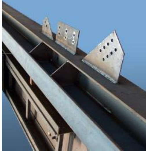
Resim 1.2: Çelik konstrüksiyon üzerinde kaynak uygulaması
