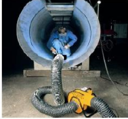
Resim 1.3: Aspiratörle kaynak dumanını emme
