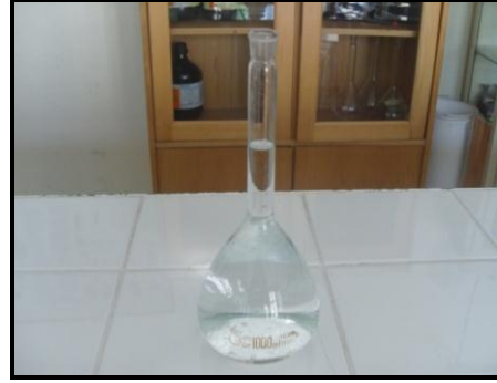
Resim 1.4: Hazırlanmış sodyum sitrat solüsyonu
