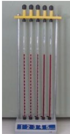
Resim 2.16: Westergreen sehpasına yerleştirilmiş sedimantasyon pipetleri
