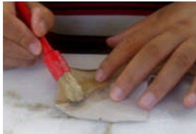
Fotoğraf 3. 4: Yüz ve yüz astarının iç kısmına yapıştırıcı sürülmesi
