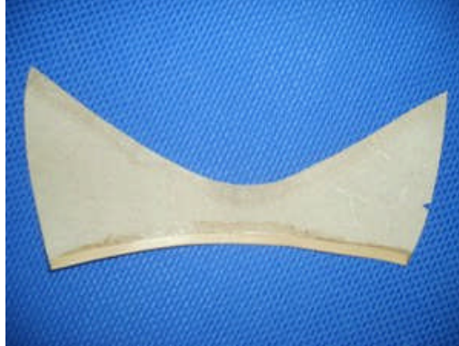
Fotoğraf 2. 6: Kırırma işlemi bitmiş yüz parçası
