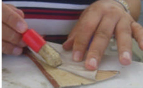
Fotoğraf 3. 6: Yüz ve astarın iç kısmına yapıştırıcı sürülmesi
