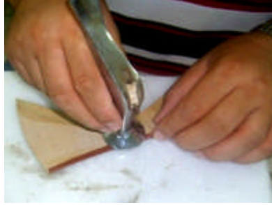
Fotoğraf 2. 5: Kırırma işleminin yapımı
