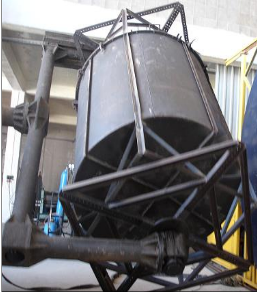
Resim 1.5: Soğutma istasyonunda dönen bir rotasyon kalıbı
