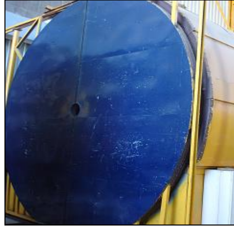
Resim 2.9: Rotasyon makinesi fırın kapıları
