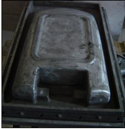
Resim 2.18: Alüminyum’dan üretilmiş rotasyon kalıbı
