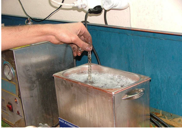
Resim 1.2: Ultrasonik yıkama makinesinde yapılan yıkama işlemi
