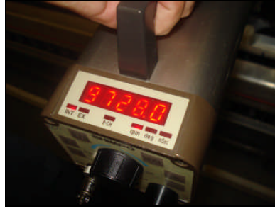
Resim 2.3: Stroboskop cihazında iğ devri değeri
