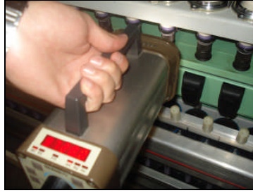
Resim 2.2: İğ devri ölçümü
