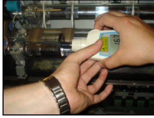
Resim 2.1: Takometre cihazı ile çıkış hızı kontrolü
