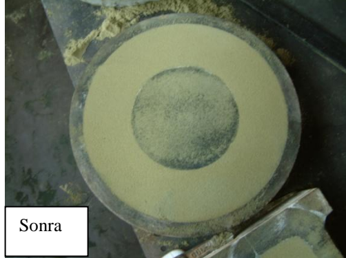
Resim 2.7: Maça sandığına beklemiş reçineli kum
