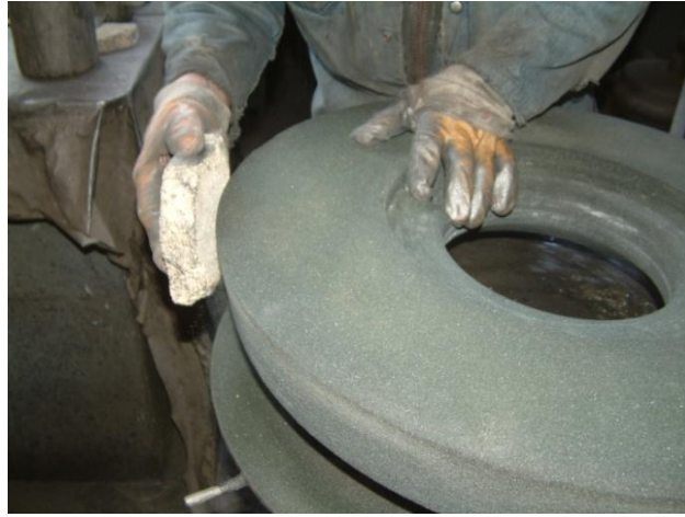
Resim 2.4: Maçanın zımpara ile temizlenmesi
