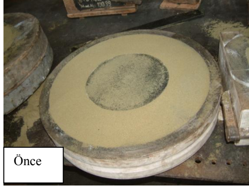
Resim 2.6: Maça sandığına yeni sıkıştırılmış reçineli kum
