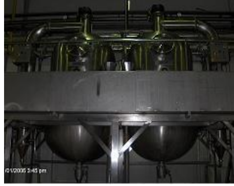
Resim 2.2: Vakumlu reçel pişirme kazanları
