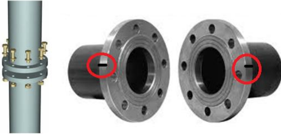
Resim 2.4: Flanşlı boru markalama
