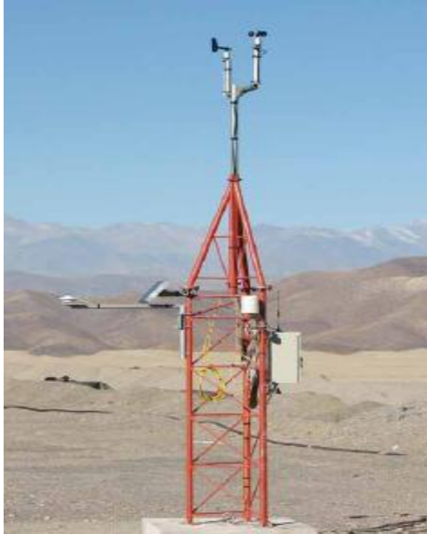
Resim 2.1: Kafes tipi ölçüm direği
