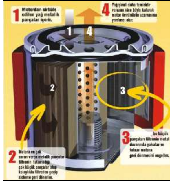
Şekil 1.2: Değiştirilmeyen elemanlı yağ filtresinin kesit görünüşü ve çalışma prensibi
