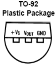
Şekil 2.9: LM35DZ Gövde görünümü
