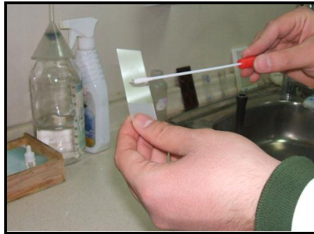
Resim 1.1: Eküvyonla materyalin lama yayılması
