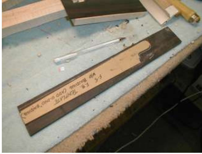
Resim 2.16: Şablon yardımıyla klavyenin ağaca çizilmesi
