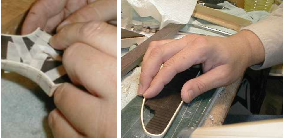
Resim 2.23: Burguluğun ve klavyenin kenarına filato yapıştırılması
