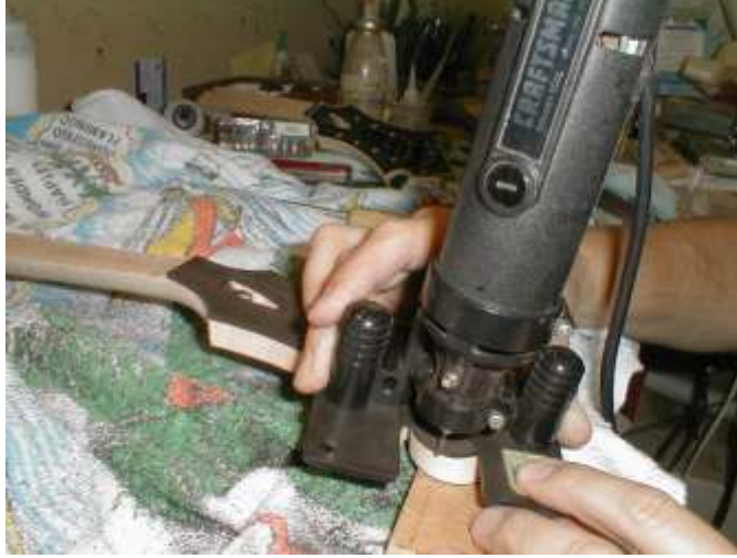
Resim 2.9: Burguluk kısmının düzeltilmesi
