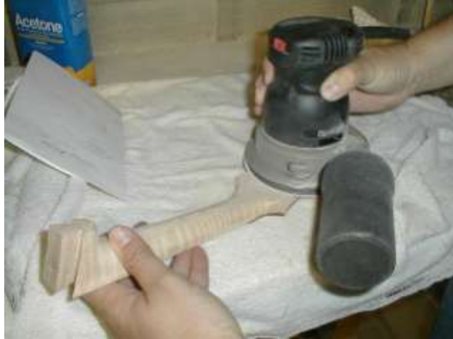
Resim 2.24: Sap kısmının temizlenmesi
