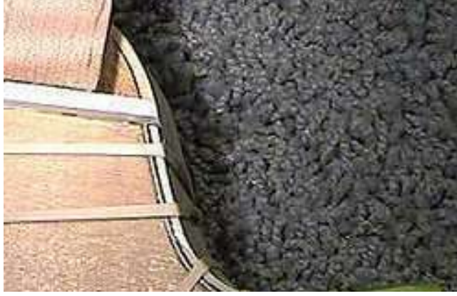
Resim 1.4: Filatonun gerdirme bantla yapıştırılması
