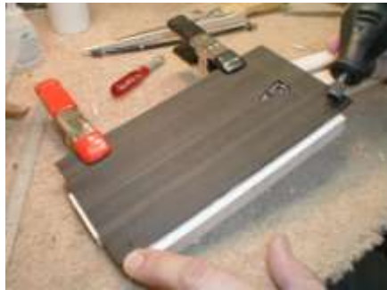
Resim 2.5: Burguluğun üst tarafına kapak yapıştırılması
