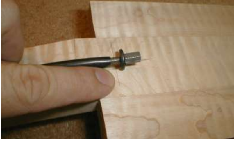
Resim 2.12: Sap gerilim mekanizması kanalının açılması
