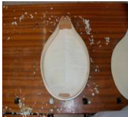
Resim 1.3: Üst tablonun geçici olarak yapıştırılması
