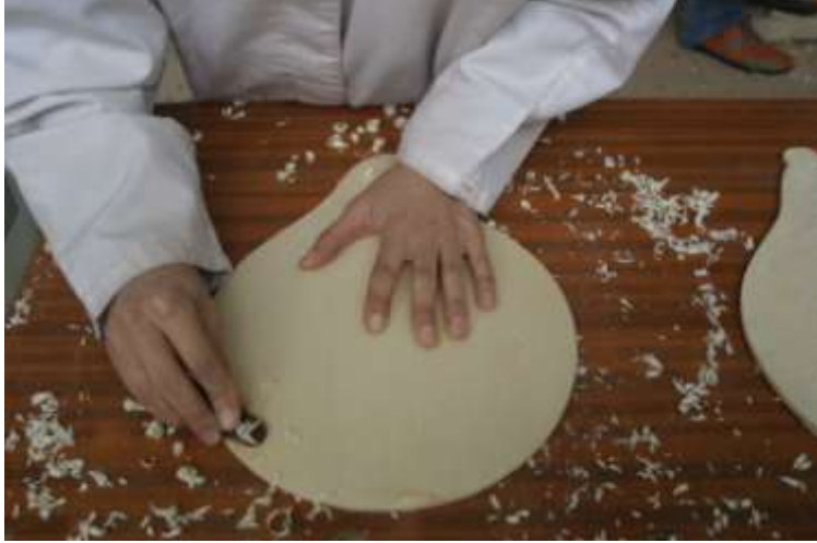
Resim 2.5: Üst tablonun temizlenmesi
