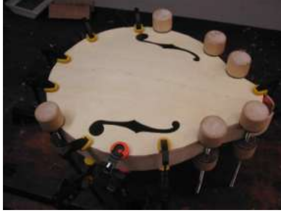
Resim 2.8: Üst tablonun yapıştırılması
