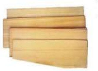
Resim 1.1: Kalıp için kontrplak malzemesi
