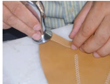
Fotoğraf 2. 16: Dikiş yerlerine açma yapılması
