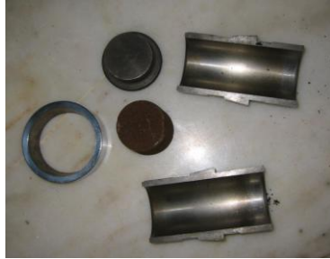
Resim 1.2: Parçalı standart deney parçası hazırlama kovası
