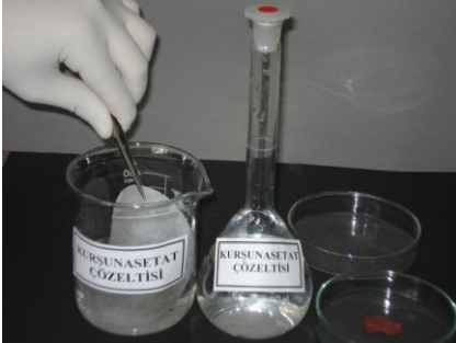
Resim 2.4: Süzgeç kâğıdını kurşunasetat çözeltisine batırma
