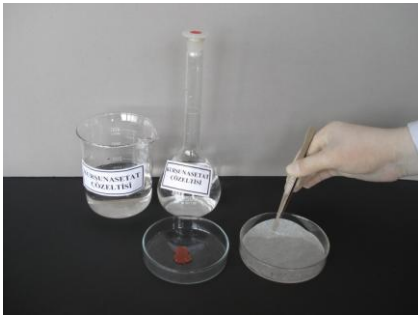
Resim 2.5: Süzgeç kâğıdını petri kutusu kapağına yerleştirme.
