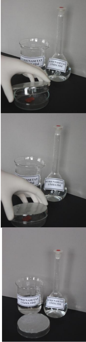
Resim 2.6 : Petri kutusunun kapađını kapatarak 10–15 dk bekletme
