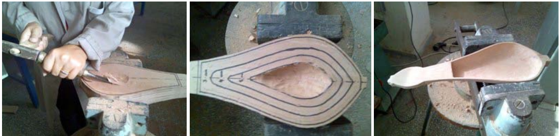
Resim 2.31: Tekne içinin oyulması Resim 2.32: Ölçülendirme Resim 2.33: Teknenin içinin oyulmuş hâli
