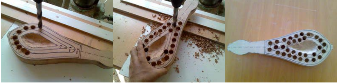
Resim 2.36: Tekne içinin çürütülmesi Resim 2.37: Çürütme Resim 2.38: Tekne içinin sulama
