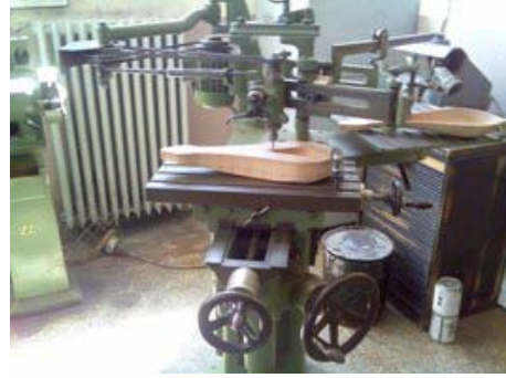
Resim 2.39: Pantograf makinesi resim 2.40: Klasik kemeç teknesinin işlenmesi
