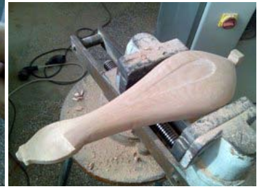
Resim 2.22: Arka formun kontrol edilmesi
