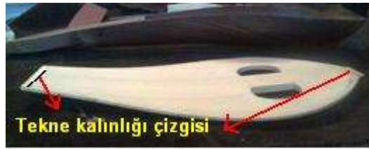
Resim 2.4: Tekne kalınlığı çizilmiş ses tablosu
