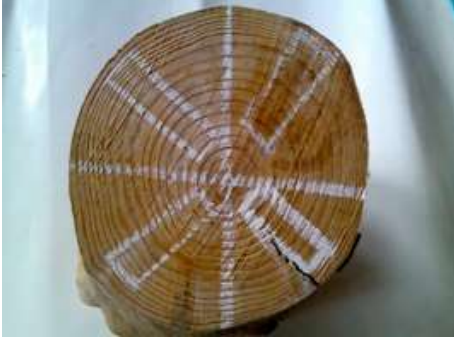
Resim 1.1: Üçe bölününce çıkarılacak kısım Resim 1.2: Dörde bölününce çıkarılacak kısım
