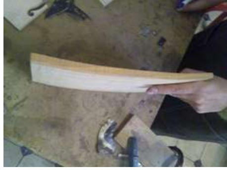
Resim 1.10: Ses tablosunun kesilmiş hâli
