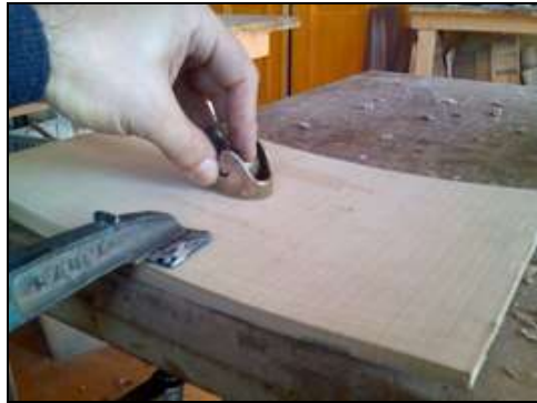
Resim 1.19: Parmak rende ile rendeleme
