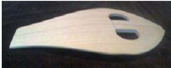
Resim 1.15: Ses tablosunun kesiminin bitmiş hâli
