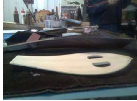
Resim 1.16: Ses tablosunun tekneye alıştırılması Resim 1.17: Tekne kalınlığının iç kısma çizilmesi
