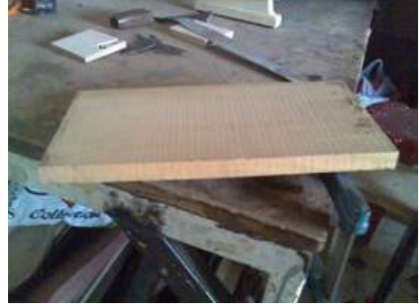
Resim 1.3: Ses tablosunun kesilmiş hâli Resim 1.4: Ses tablosunun yıllık halka durumu
