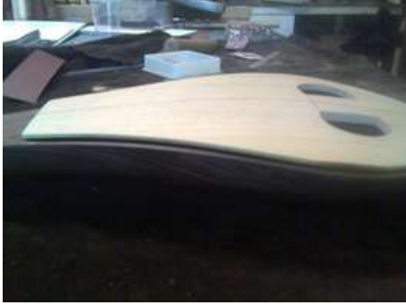
Resim 1.16: Ses tablosunun tekneye alıştırılması Resim 1.17: Tekne kalınlığının iç kısma çizilmesi
