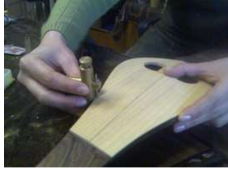
Resim 2.10: Nişangeçle filato yerinin markalanması
