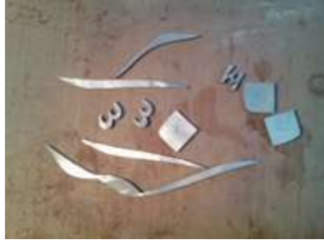
Resim 1.5: Zemine göre hazırlanan sedef parçalar
