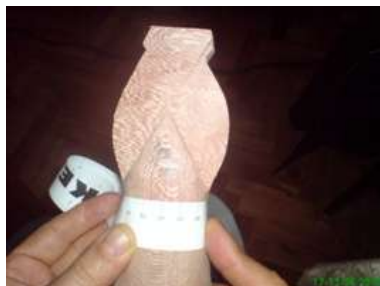
Resim 1.9: Sap arkası bitiş ölçüsünün alınması
