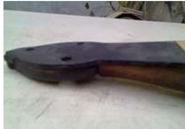
Resim 2.6: Sap üzerinin yapıştırılmış hâli
