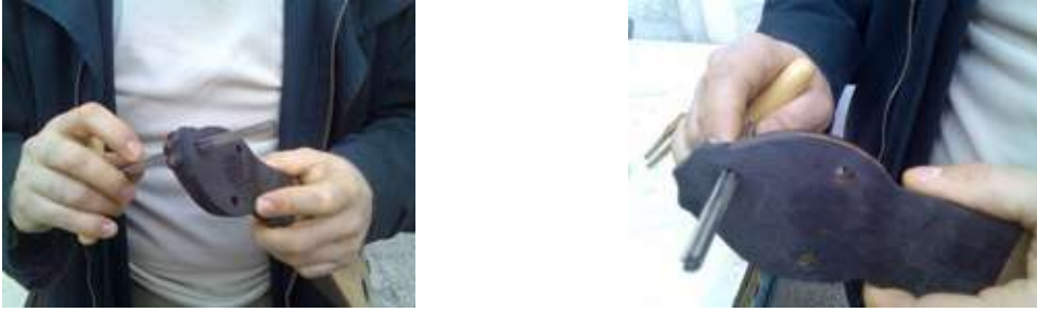
Resim 3.3: Burguluk yerlerinin rayba ile konikleştirilmesi
