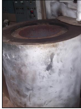
Resim 1.1: Sementasyon işleminde kullanılan kapalı ve hava geçirmez kutu
