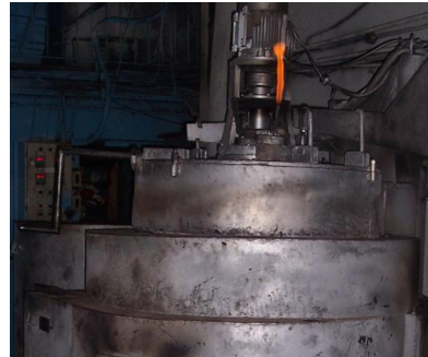
Resim 3.1: Gaz sementasyon fırınları ve gaz verme tertibatı
