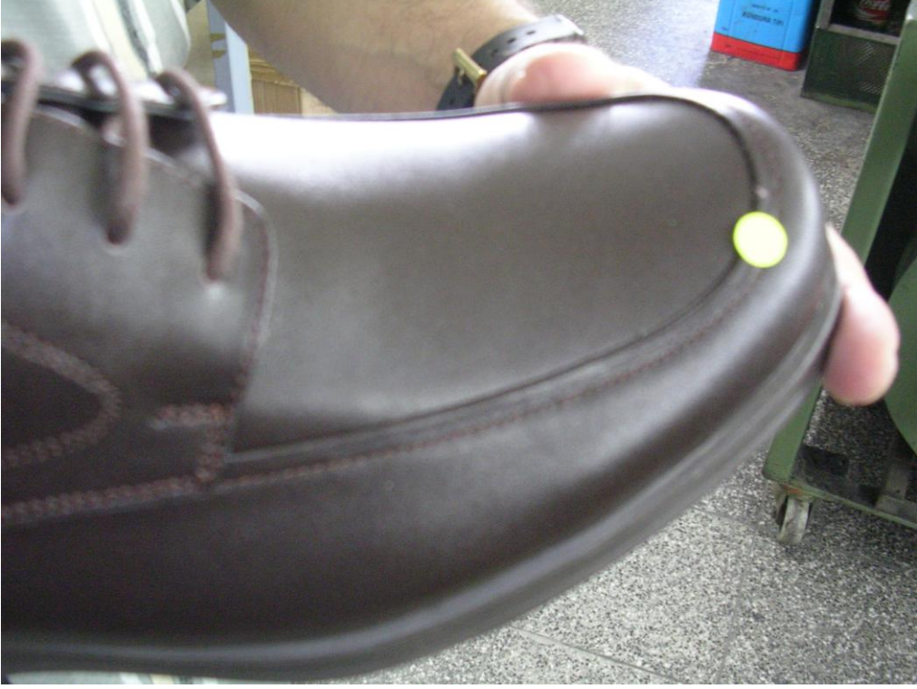
Resim 2.2: Üretimi biten ayakkabıda gözle yapılan kontrolde buluna hatanın işaretlenmesi
