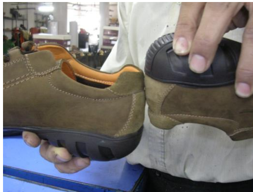
Resim 2.1: Üretimi biten ayakkabıların arka yüksekliklerinin kontrolü
