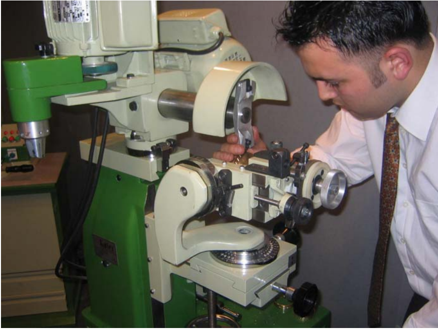
Resim 2.8: Çeşitli kalem atma makineleri ve kalem atma işlemi
