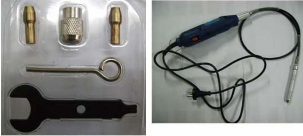
Resim 1.6: Amerikan kaleminde kullanılan freze motorları ve yardımcı aparatlar
