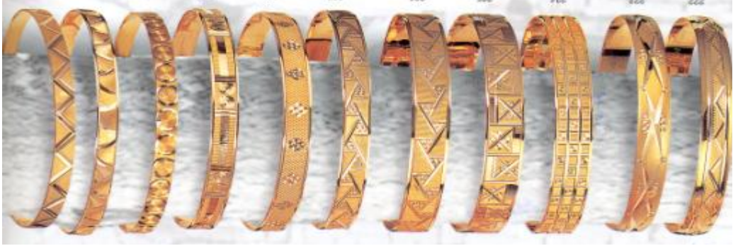
Resim 1.1: Kalem atılarak yüzey kalitesi artırılmış bilezikler
