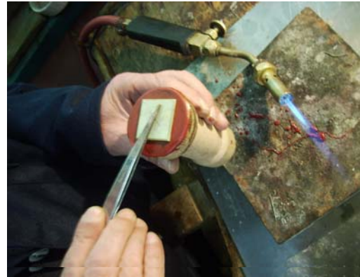
Resim 2.3: Takıların rokelaya pevla yardımıyla yapıştırılması
