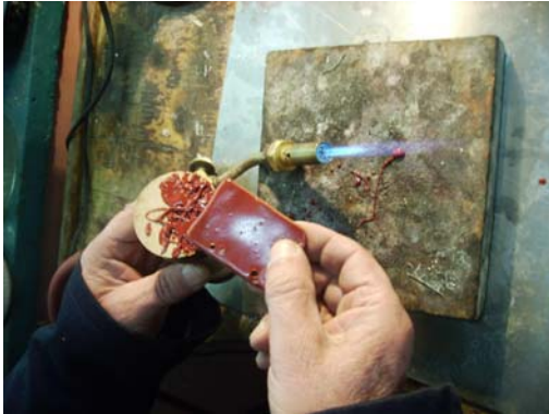
Resim 2.3: Takıların rokelaya pevla yardımıyla yapıştırılması
