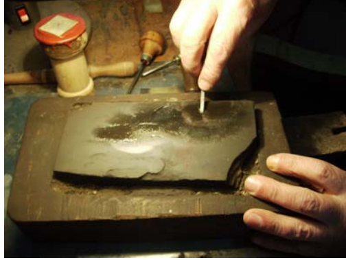
Resim 2.4: Çelik kalemlerin bilenmesi ve kalem atmaya hazırlanması
