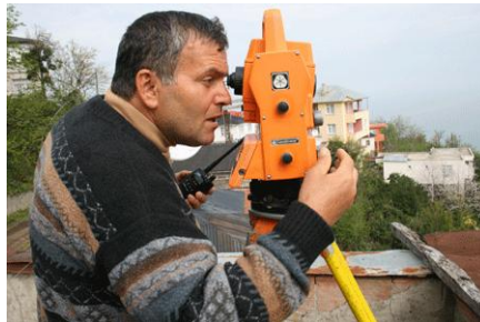
Resim 3.1: Parsel sınırının ölçümü
