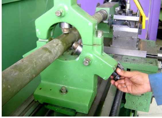
Resim 1.5: Yatak enelerini iŒe gre ayarlama
