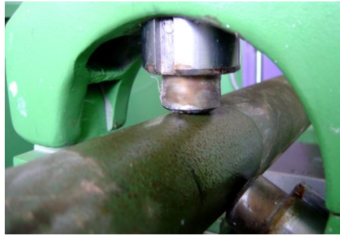
Resim 1.7: Yatak enelerini presleme
